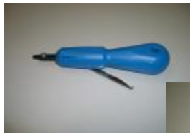
-> Anlegewerkzeug Quante SIE71 - für Siemens Trennleisten 71
